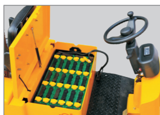
大容量电池位于框架的最低部分，提供低重心
