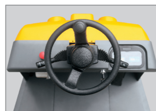
可调节方向盘，带前进/后退操纵杆
