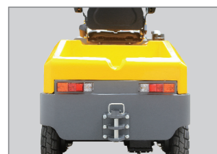
后盖方便拆卸，易于维护
