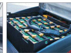
大容量蓄电池, 盖板加装安全锁扣, 可翻转成直角, 以便取出
